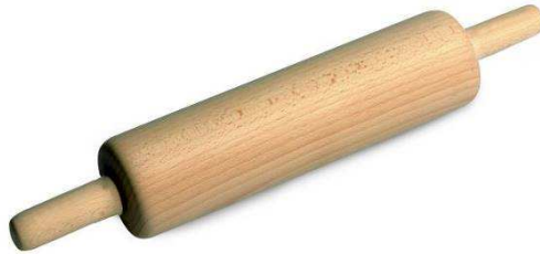
(شكل رقم ١) نموذج خشبي لشمعة الفلتر لعمل القالب عليه
