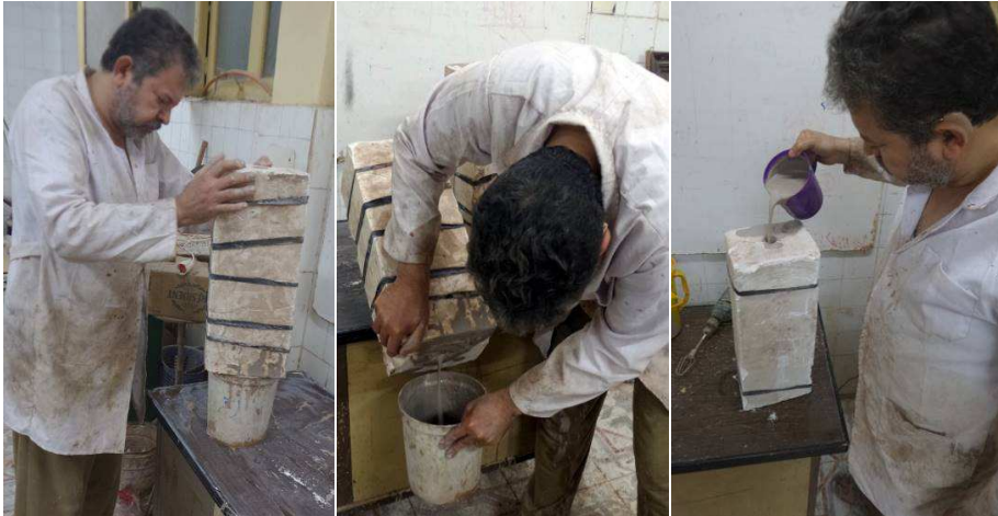
(شكل رقم ٥) صب الطين السائل وتفريغه
