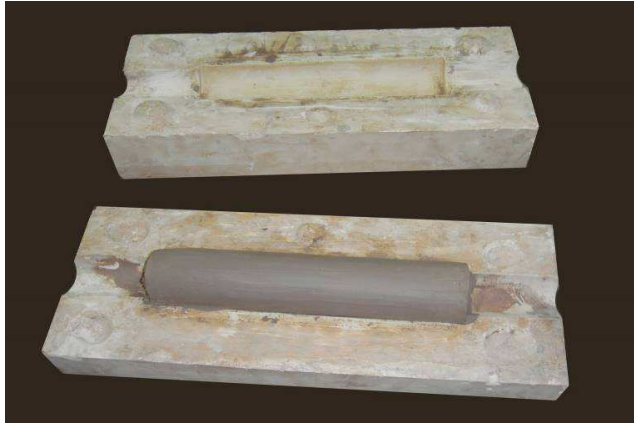
(شكل رقم ٣) تشكيل النموذج بالضغط في القالب
