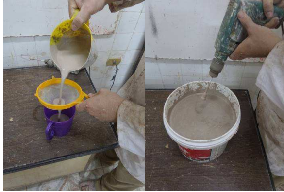
(شكل رقم ٤) تجهيز طين وخطط طين الصب السائل وتصفيته
