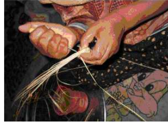
الصورة رقم (٧) توضح طريقة تصنيع المشغولات الخوصية.(١*)
