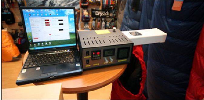
صورة (١) جهاز (Permetest Apparatus (Skin Model) المستخدم لقياس العزل الحرارى، ففاذية بخار الماء
