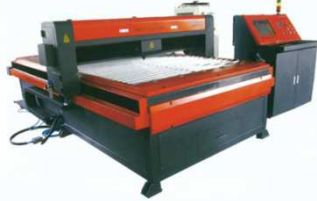
شكل (١٤) ماكينة القطع بأشعة الليزر Lasre Cutting Machine.
